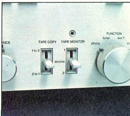
Le manopole sono di plastica, rivestite di alluminio. Il particolare della pulsantiera mostra l'interruttore per la variazione della capacità dell'ingresso phono. Il comando di tape monitor è dotato di led spia che ne rende visibile l'attivazione.
